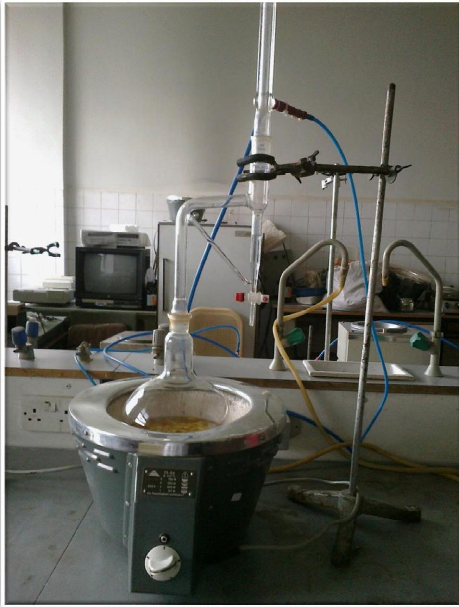
الشكل (10) جهاز الاستخلاص Clevenger apparatus (التقاط الباحثة).
