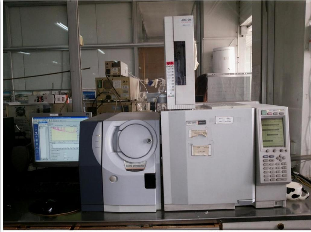
الشكل (12) جهاز الكروماتوغرافيا الغازية ومترحي مطياف الكتلة GC-MS (التقاط الباحثة).
